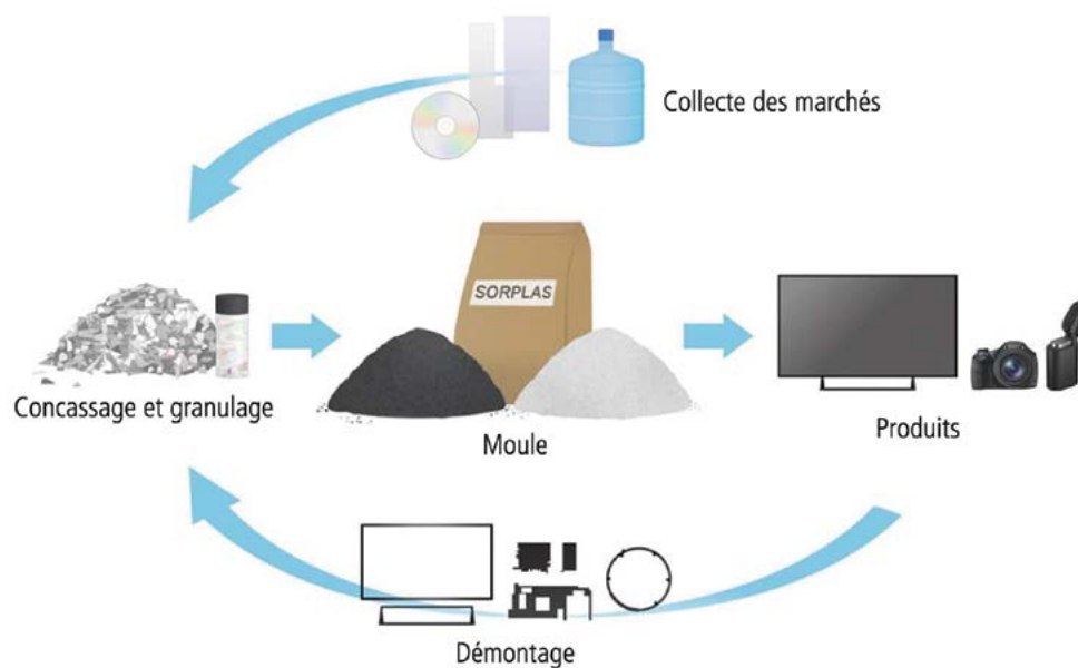
Procédé de recyclage SORPLAS™ de Sony. Image gracieusement fournie par Sony North America.
