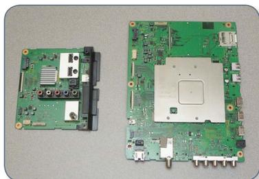
Cartes de traitement des téléviseurs à LCD; 2014 (gauche) et 2013 (droite)
